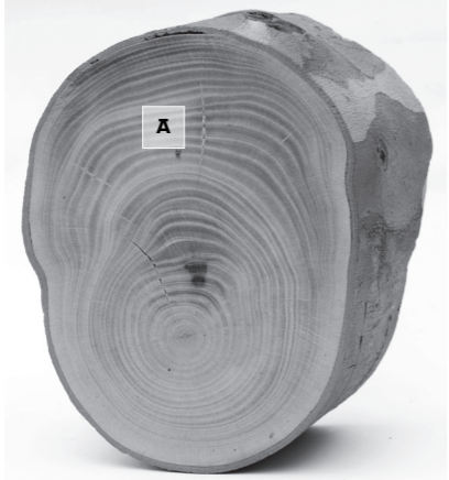
Section transversale ovoïde d'une branche d'un platane commun (Platanus × hispanica Mill. ex Münchh.). Le bois de tension (A) se trouve dans la partie supérieure. ↓↓
