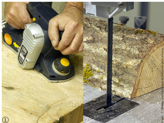
① Rabotage pour aplanir la section transversale d'un tronç. ② Utilisation d'une scie à ruban afin de recouper « proprement » une portion de branche sciée grossièrement à la tronçonneuse.
